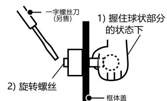
● 如下图所示，拆分出零部件。
