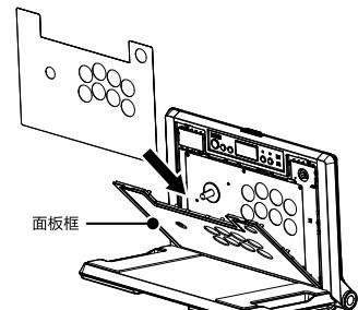
④ 合上面板框, 将按钮、螺钉和摇杆恢复到原始状态, 然后合上框体盖。
