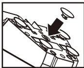
取り付ける向きに注意して、5つの吸盤をステアリングユニット底面に取り付けます。
