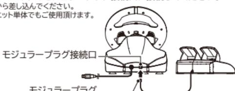
2. ステアリングユニットのUSBプラグをNintendo SwitchドックのUSB端子に接続してください。
