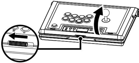
2) 筐体カバーを開き、ケーブルの巻き付け部分からUSBケーブルを引き出してください。
