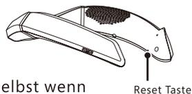
Sollte das Laden nicht möglich sein, das Gerät nicht reagieren selbst wenn es vollständig aufgeladen ist oder es selbständig reagiert, drücken Sie die Reset - Taste innerhalb des Necksets mit einem langen, dünnen Gegenstand um das Gerät zu resetten und neu zu verbinden.
