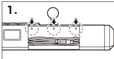
1. USBケーブル収納ボックス内にある、3本のネジを取り外します。
