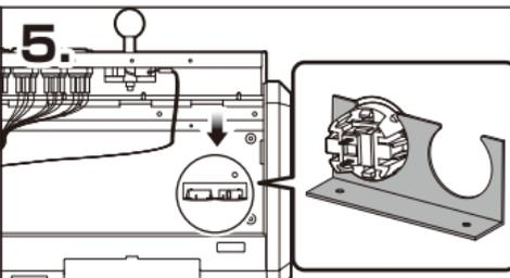
5. 取り出したボタンおよびボタンキャップは、コントローラー内部の図の箇所に2個収納できます。
