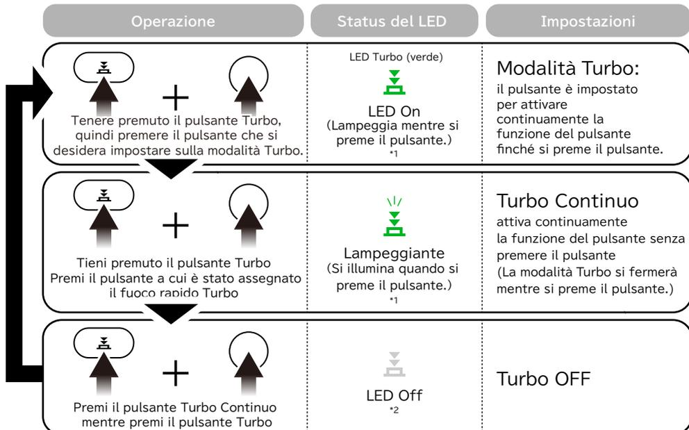
\*1 Il LED Turbo (verde) lampeggerà ad una velocità corrispondente alla velocità Turbo.
