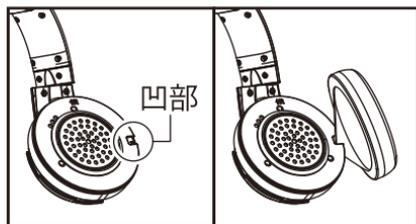
イヤーパッドの1部分をイヤークップの凹部に引っ掛けるように取り付けます。
