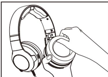
ヘッドセットのイヤークップ部分をしっかりと持ち、イヤーパッドの内側に指を入れ外側に軽く押し出すように持ち上げます。
