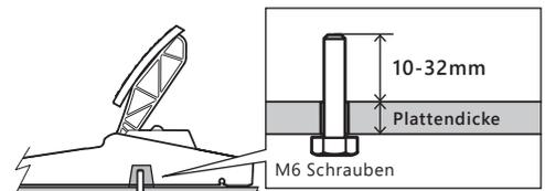
M6 Schrauben mit einer Länge von 10 bis 32mm + Plattendicke können verwendet werden.
