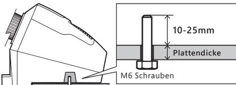
M6 Schrauben mit einer Länge von 10 bis 25mm + Plattendicke können verwendet werden.
