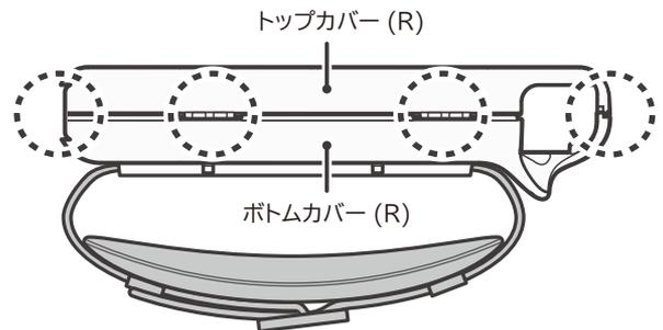
※ 4箇所のツメ部分が外れるように、トップカバーとボトムカバーを
