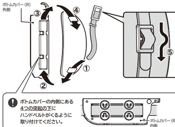
❗ ボトムカバーの内側にある4つの突起の下にハンドベルトがくるように取り付けてください。
