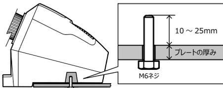
プレートの厚み + 10 ~ 25mm の長さの M6 ネジを使用することができます。
