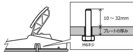
プレートの厚み + 10 ~ 32mm の長さの M6 ネジを使用することができます。
