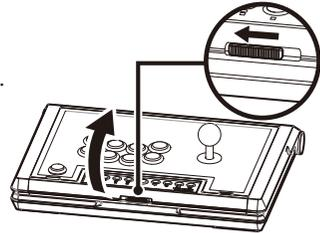
② Voltea ambos paneles y coloca el stick en una superficie resistente, de modo que repose sobre la cara interior del panel inferior y el panel superior quede vertical.
