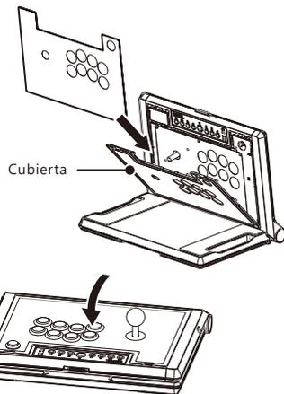
④ Cierra la cubierta, vuelve a colocar los botones, tornillos y bola del stick en su posición original y cierra el cuerpo del stick.
