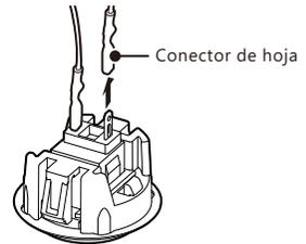
2) Aprieta poco a poco los dos topes del botón para extraerlo del panel, como se muestra en el diagrama.
