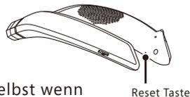
Sollte das Laden nicht möglich sein, das Gerät nicht reagieren selbst wenn es vollständig aufgeladen ist oder es selbständig reagiert, drücken Sie die Reset - Taste innerhalb des Necksets mit einem langen, dünnen Gegenstand um das Gerät zu resetten und neu zu verbinden.
