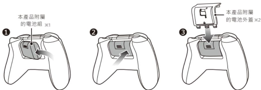
※1 安裝電池時，請以正確的方向安裝。如果電池安裝方向錯誤，則無法充電，並且可能導致故障，請注意。
