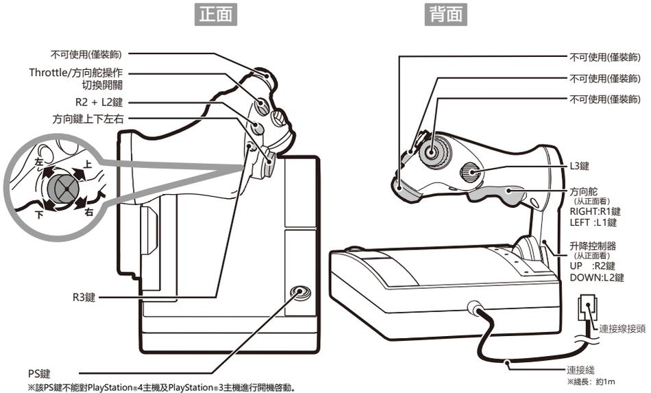
※以上的方向舵的設置是「升降/方向舵操作切換開關」1的操作模式。
